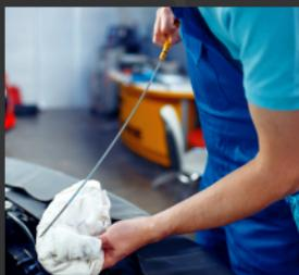
Mit dem Ölmesstab kannst du den aktuellen Öl Pegel messen. Der Pegel muss zwischen Minimum und Maximum sein
