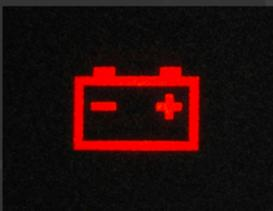
Die Ladekontrollleuchte informiert dich dass deine Batterie nicht mehr geladen wird. Bald fällt die Elektrik aus. Denk daran Rot ist BÖSE. Du solltest nicht mehr weiterfahren.
