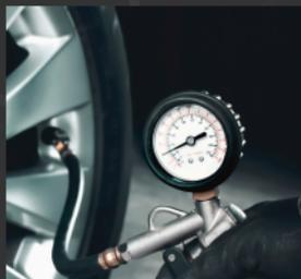
An Tankstellen kannst du mit einem Kompressor den Luftdruck prüfen und wenn nötig direkt auffüllen. Deinen Luftdruck findest du im Tankdeckel oder der Fahrertüre. Nicht auf dem Reifen!
